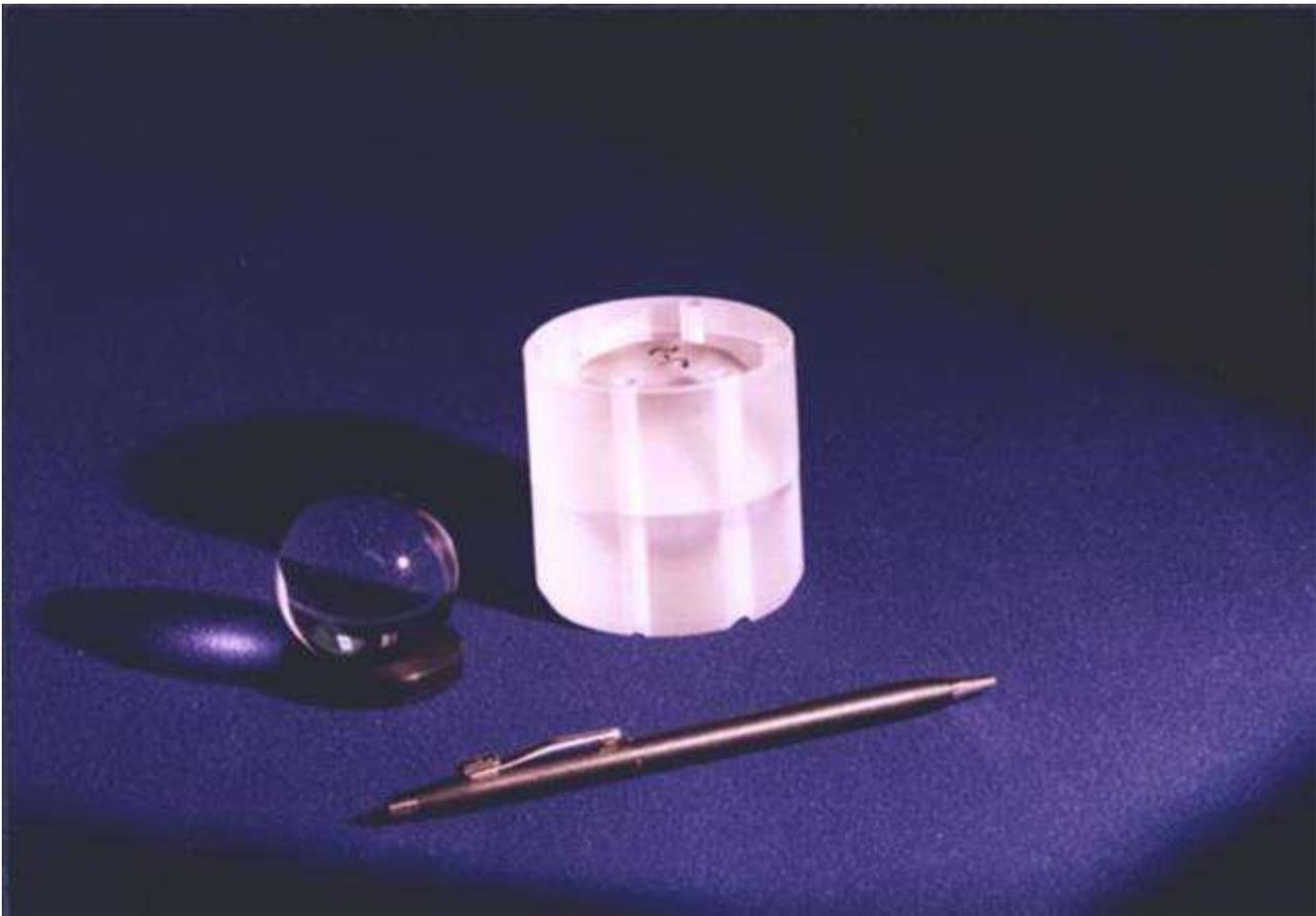
Vue du Gyroscope ( en quartz non métallisé) et de sa coquille en quartz
