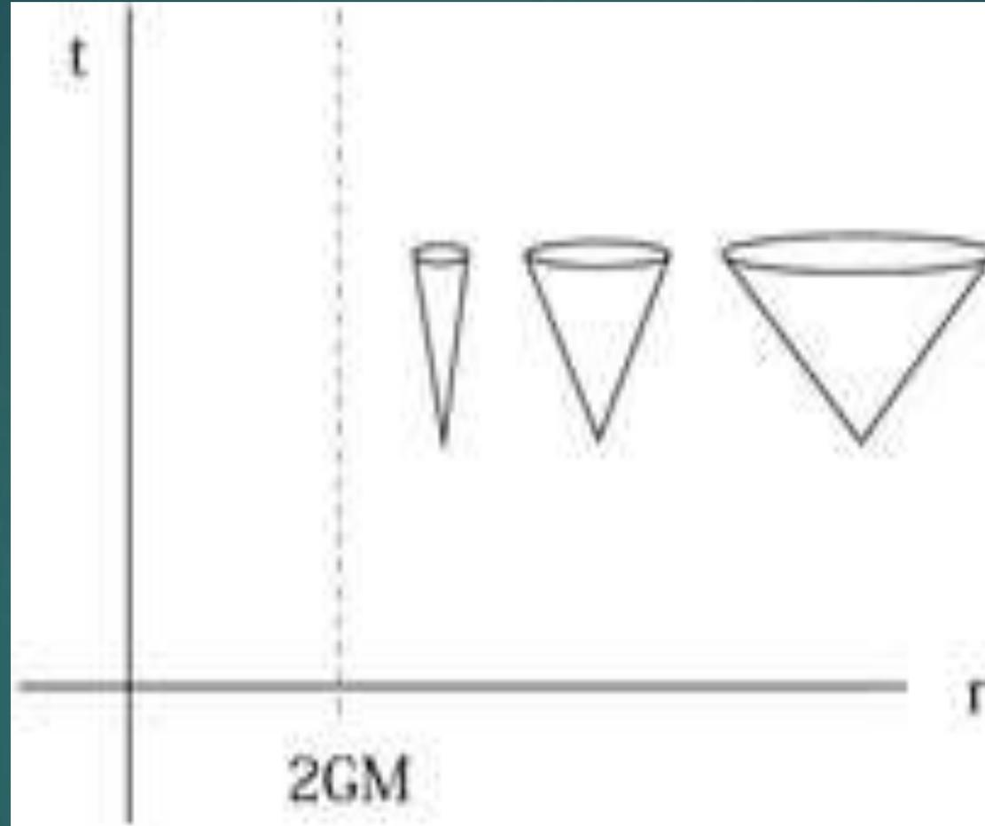
Allure des cônes de lumière sur une géodésique radiale, définis par  $dr/dt = \pm (1-r_s/r)$ , à partir de:
